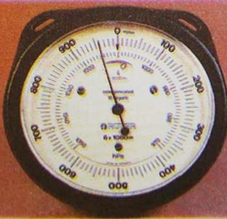
جهاز قياس الارتفاعات، يستعمل عموما في الملاحة الجوية .
